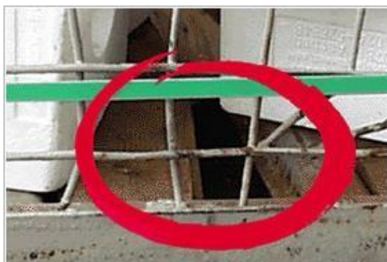
Abbildung 27: Gitterbox – Bretter beschädigt
