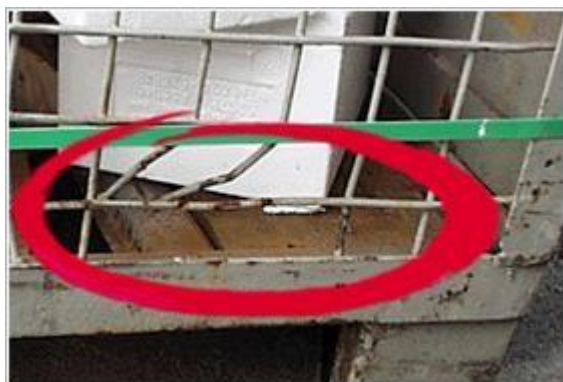
Abbildung 26: Gitterbox- Rundstahlgitter gerissen
