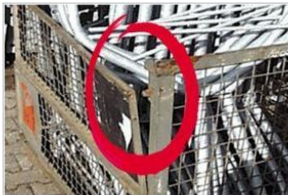
Abbildung 24: Gitterboxen – Klappen beschädigt
