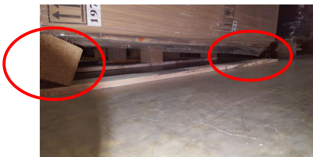
Abbildung 21: Palette – Beschädigung Klötze
